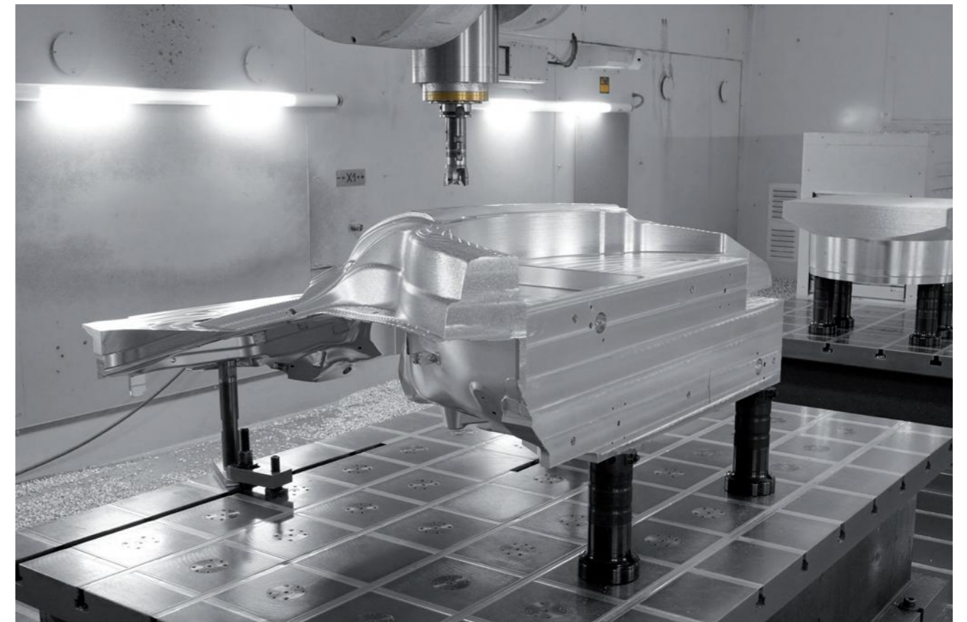
大型复杂铝制组件，使用零点定位系统可实现灵活装夹。
