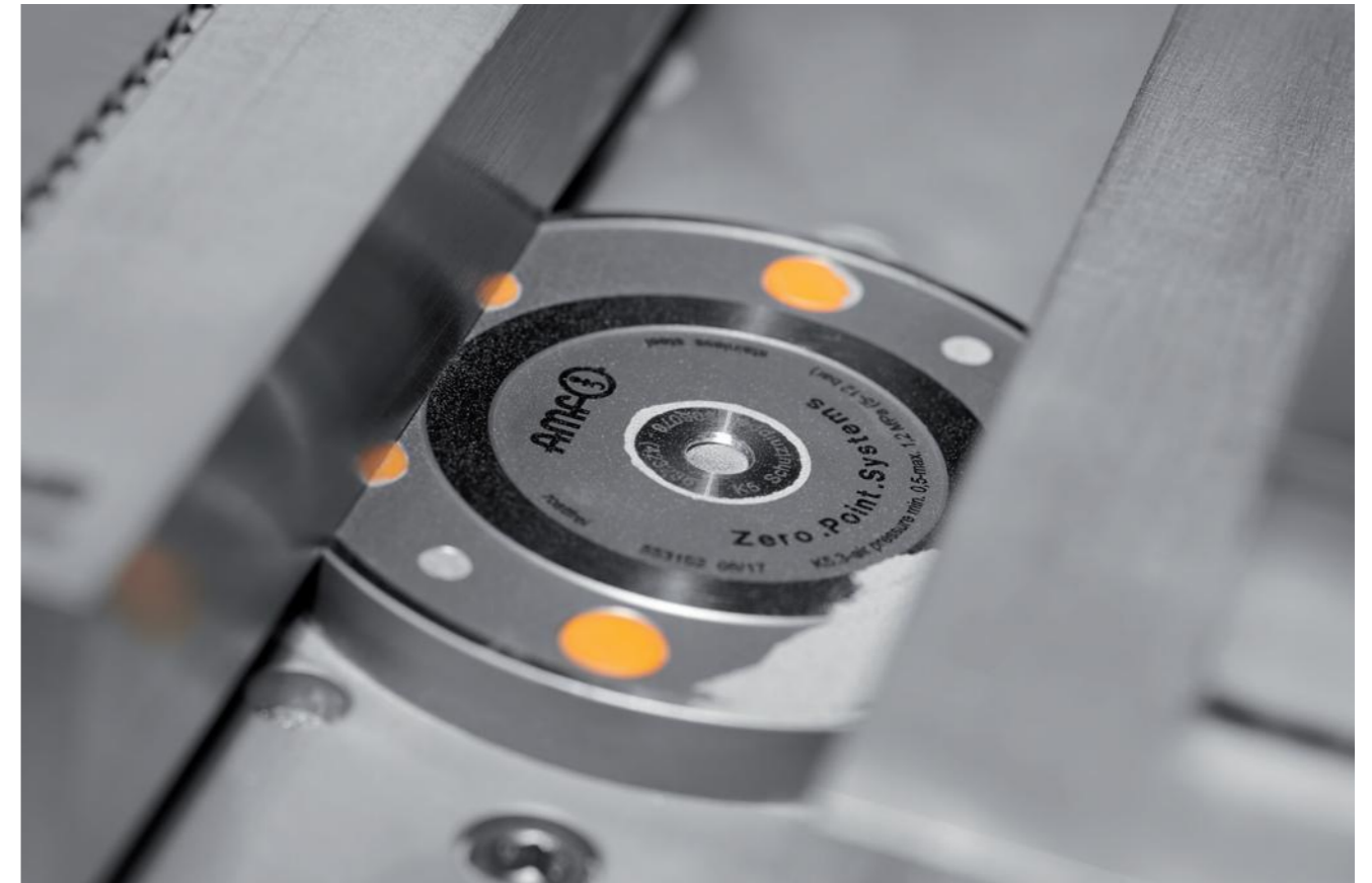
AMF专为增材制造（3D打印）和高温环境设计的零点定位系统。完全密封的设计，可以免受金属粉末的影响。
