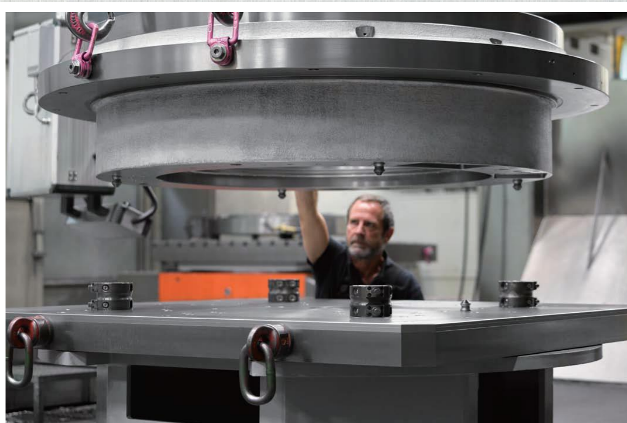
双头零点定位单元可以被用来快速调节间距，从而使小批量多品种零件的装夹更快速，更简单。
