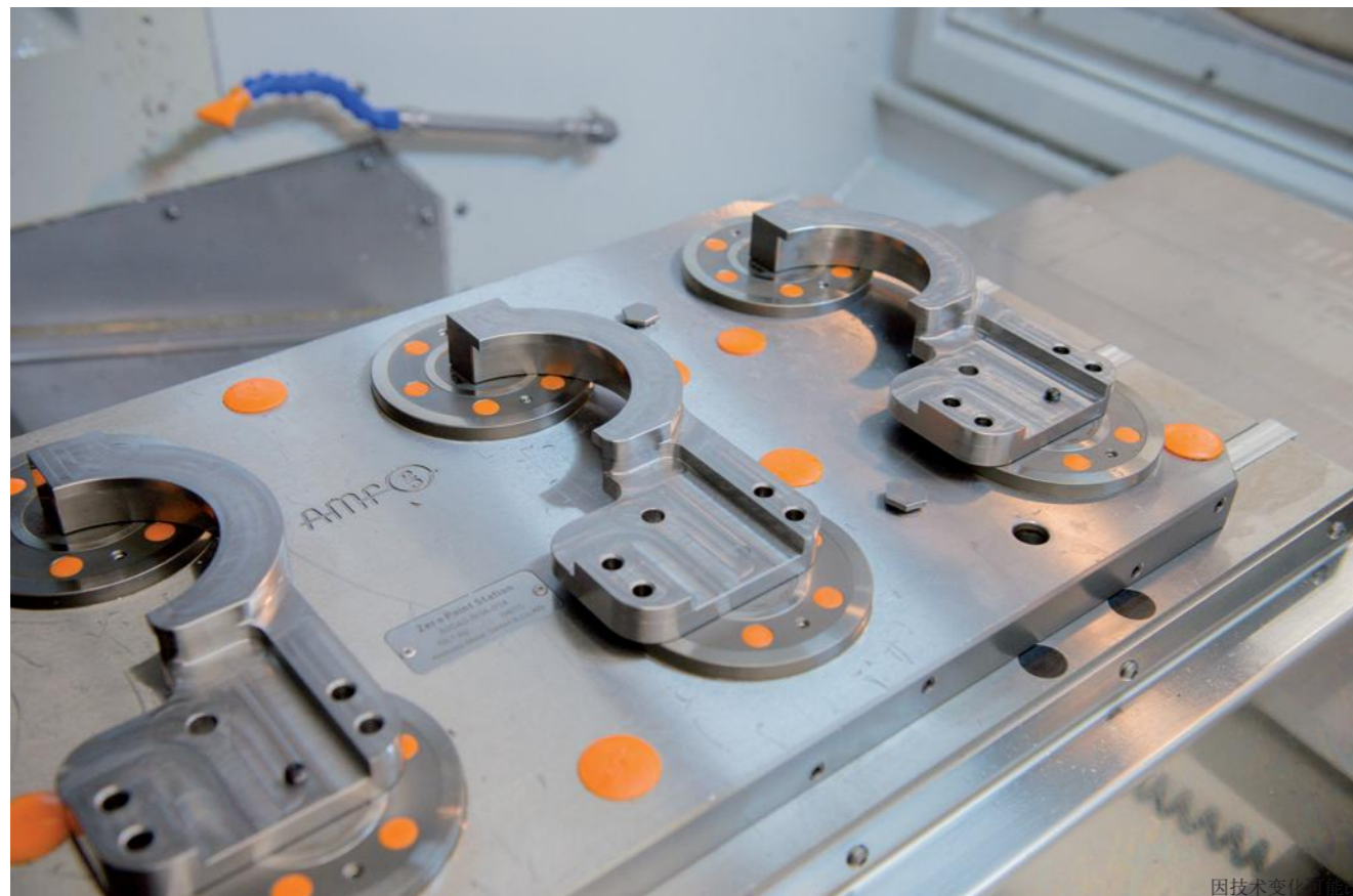
8单元零点定位系统实现虎钳、卡盘等夹具的快速切换
