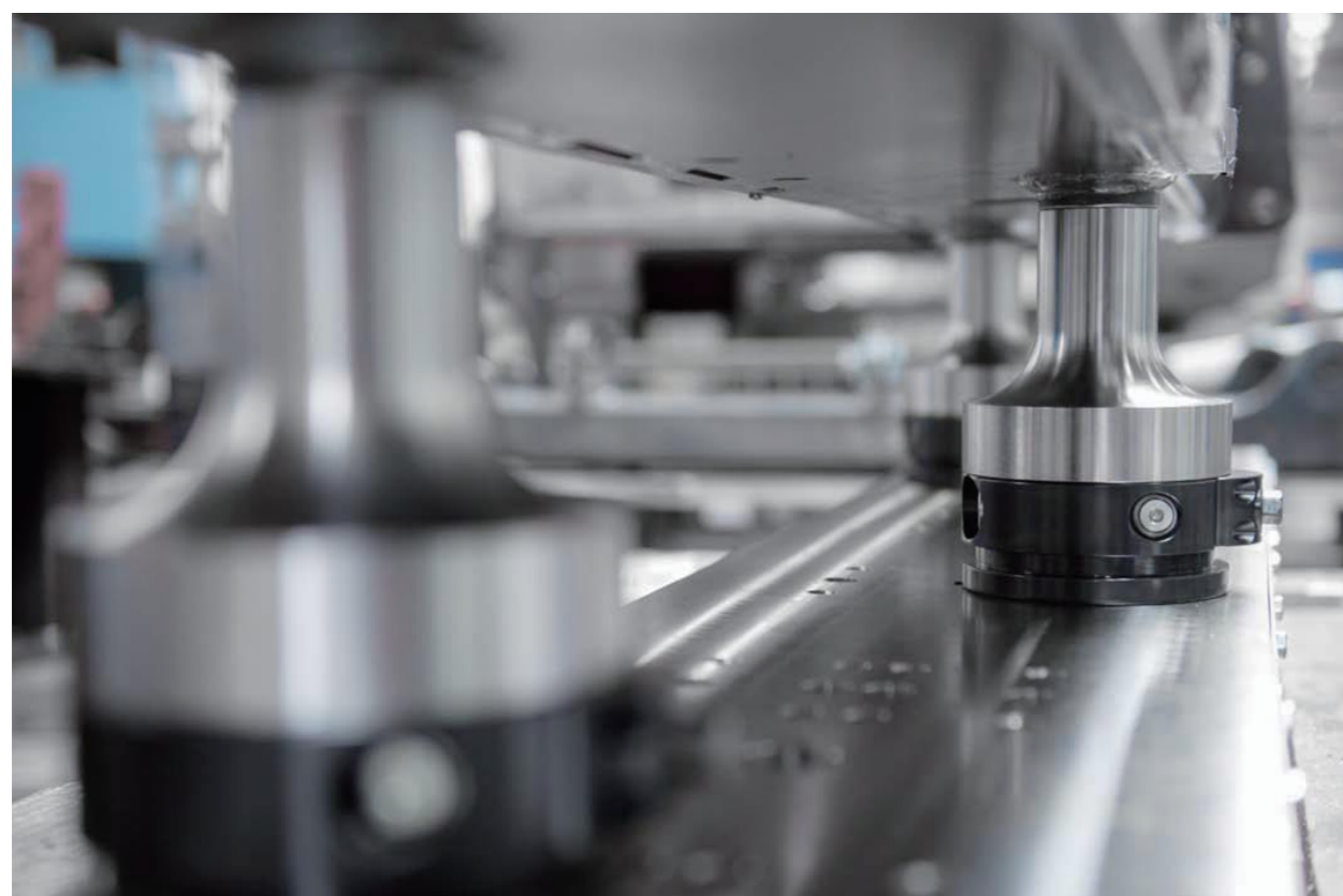
双头零点定位单元可以被用来快速调节间距，从而使小批量多品种零件的装夹更快速，更简单。
