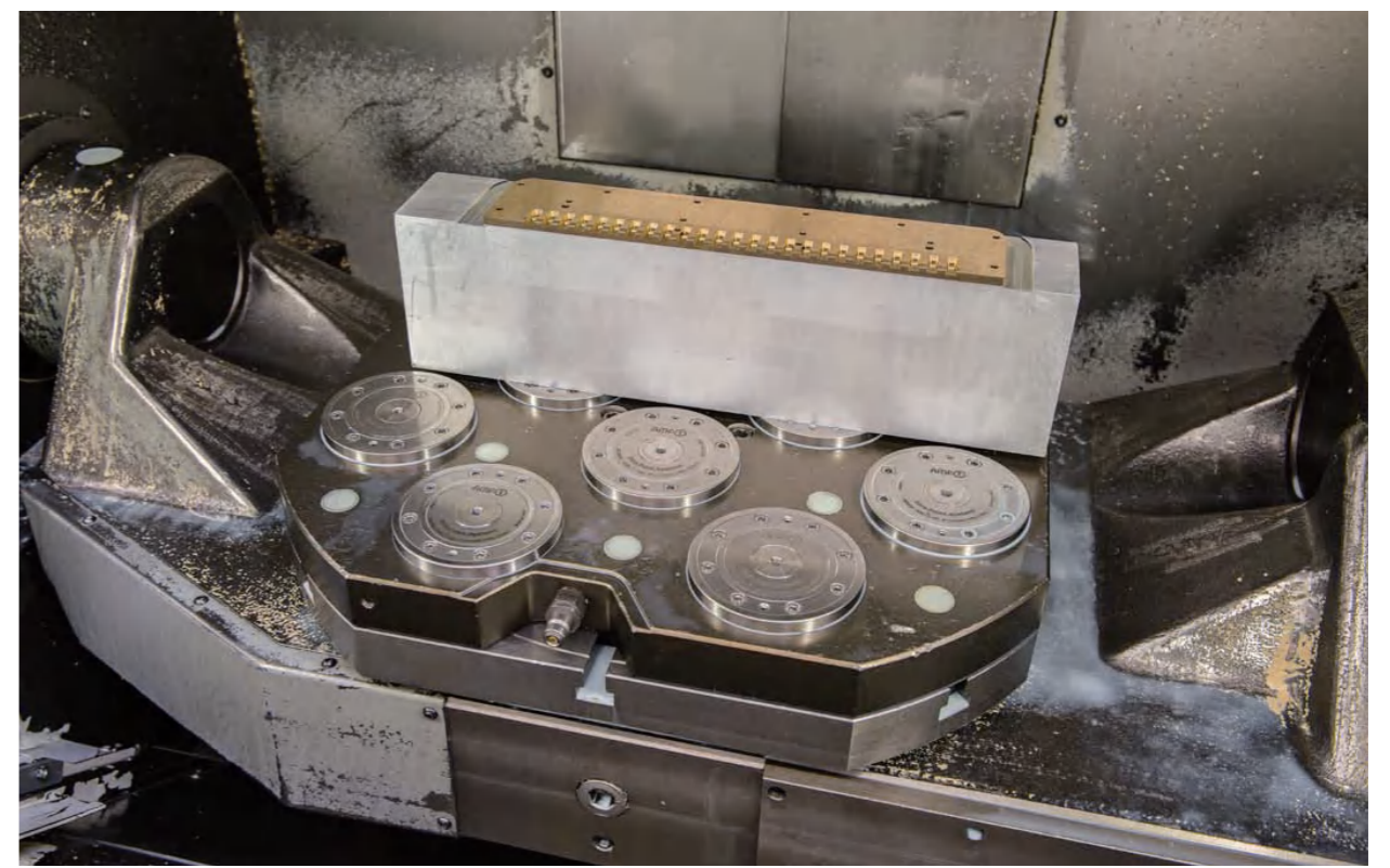
AMF零点定位系统用于模具装夹
