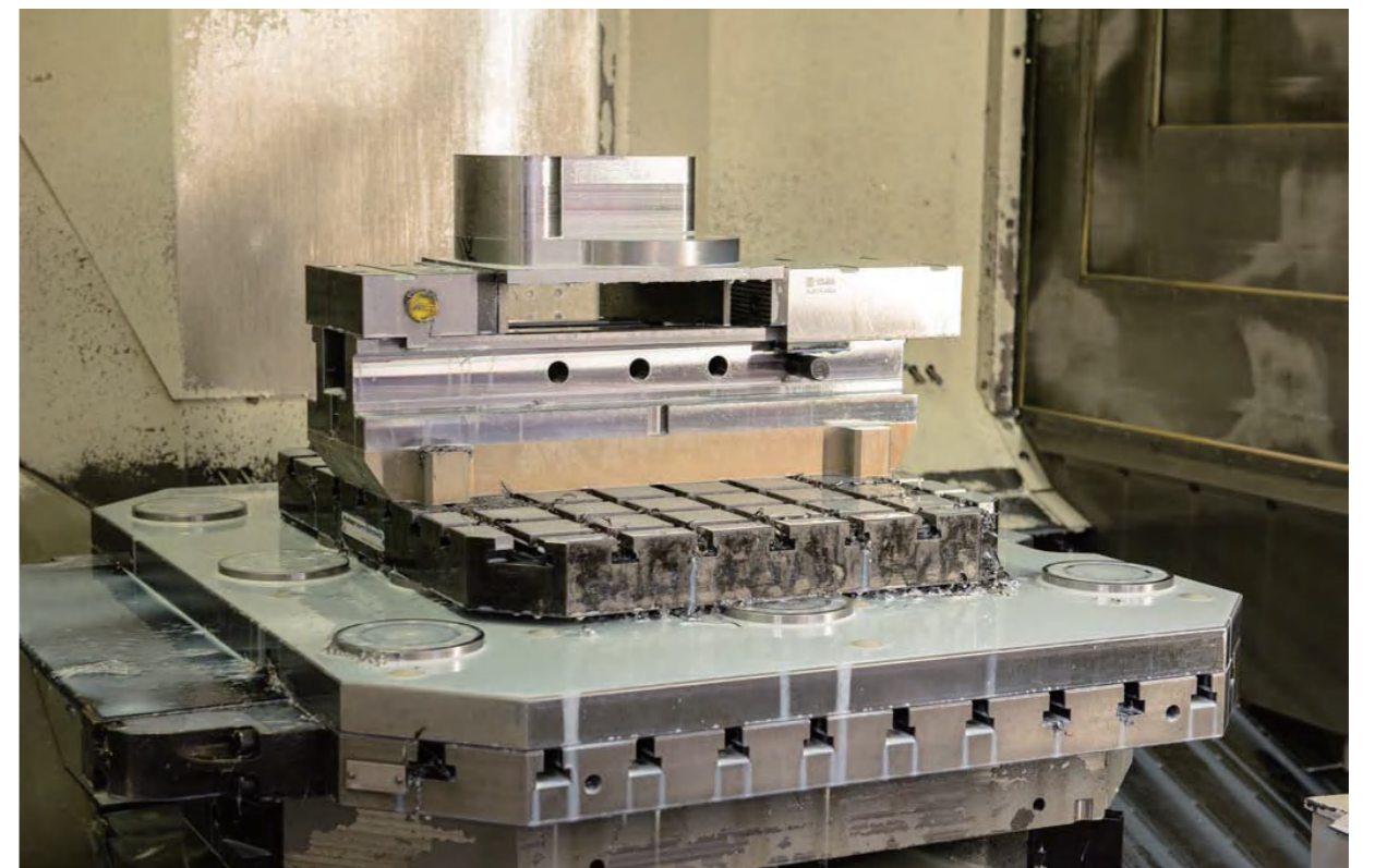
AMF零点定位系统用于模具装夹
