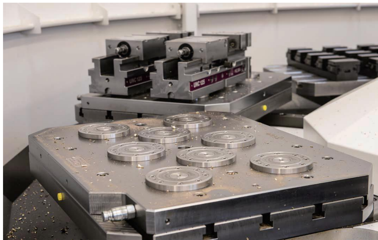
通过零点定位系统扩展多托盘系统的容量
