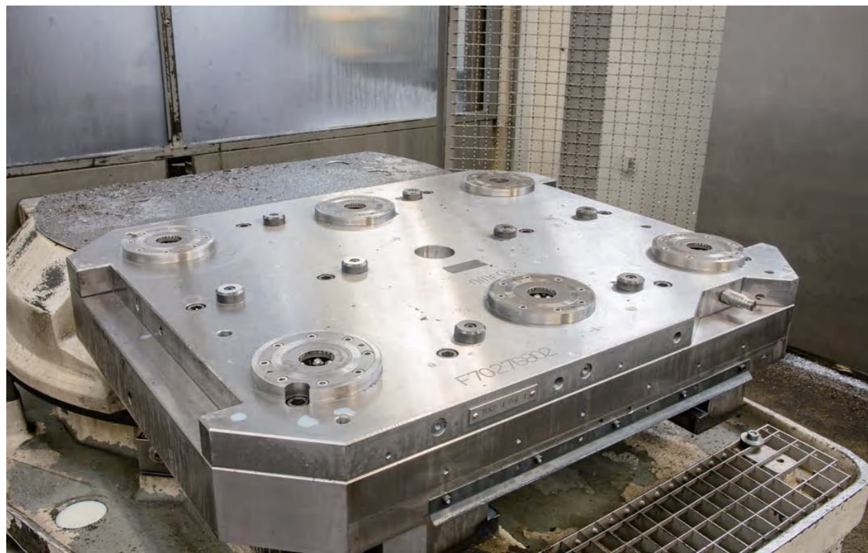
AMF零点定位系统用于大型发动机缸体的加工，通过零件装夹的托盘化，大幅缩短装夹时间。
