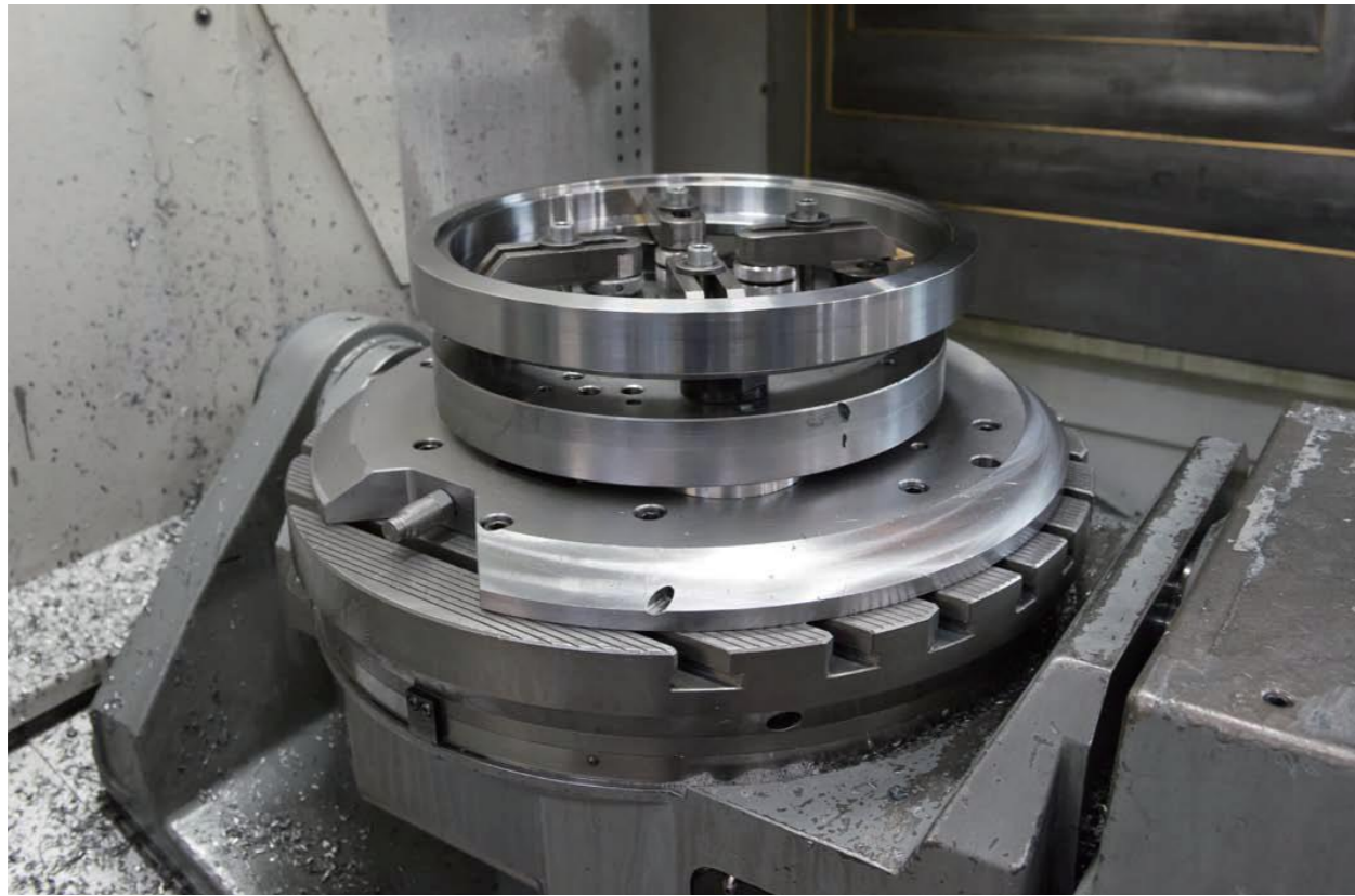
五轴加工中心使用零点定位系统实现零件的离线装夹，大幅提高加工效率
