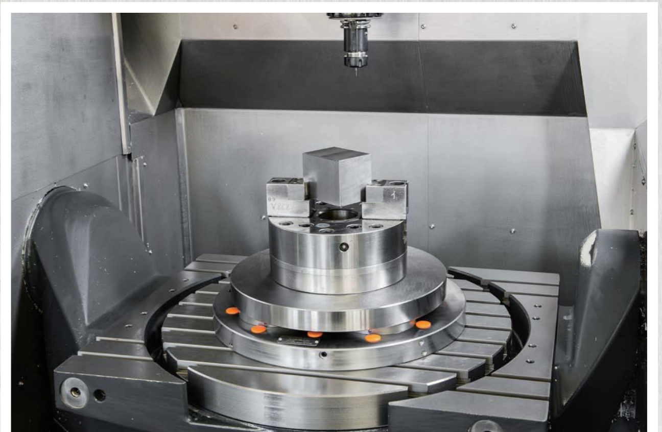
四单元零点定位系统用于五轴加工中心，最大转速可达2200rpm。
