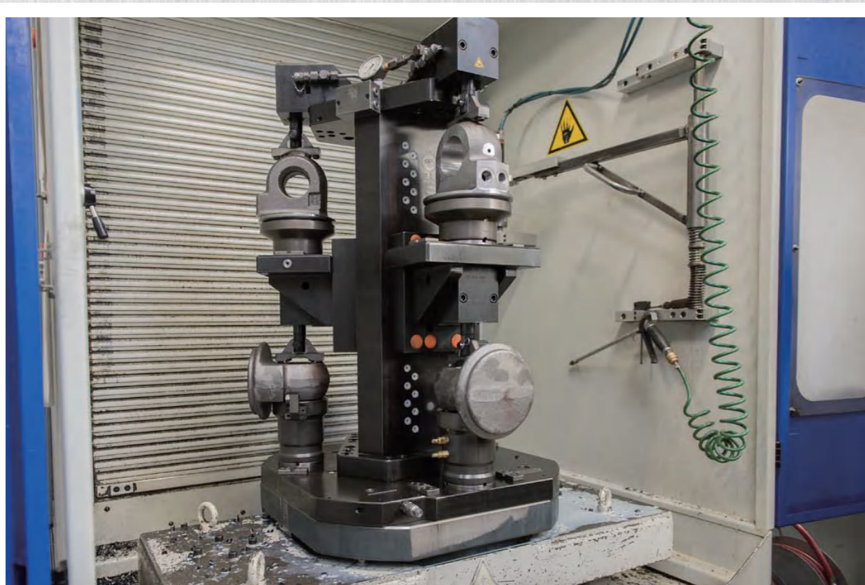
AMF成套液压夹具，多工序，多规格通过一套夹具实现（采用了模块化夹具，液压夹具，以及零点定位系统）
