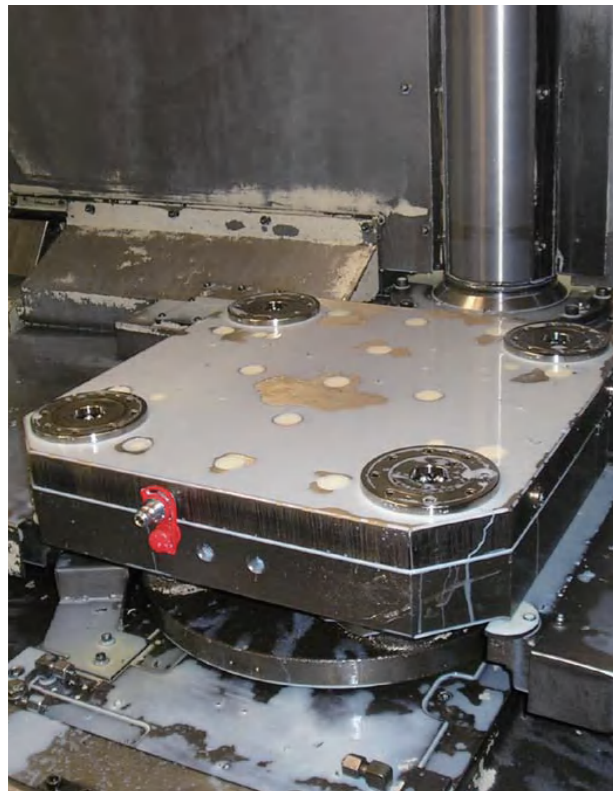
零点定位系统是完全密封的系统，可以隔绝切削液和铁屑
