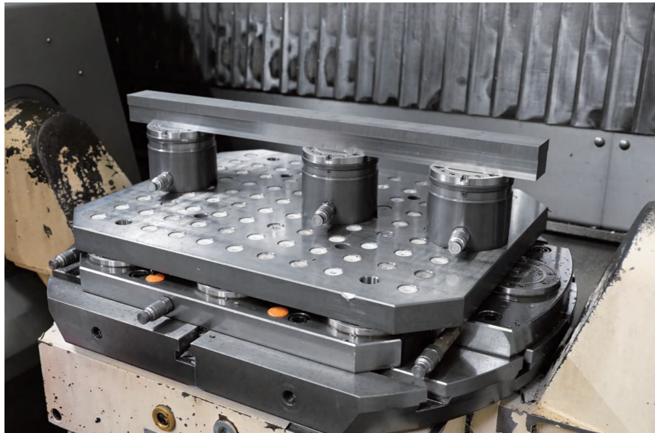
AMF零点定位系统实现五面加工
