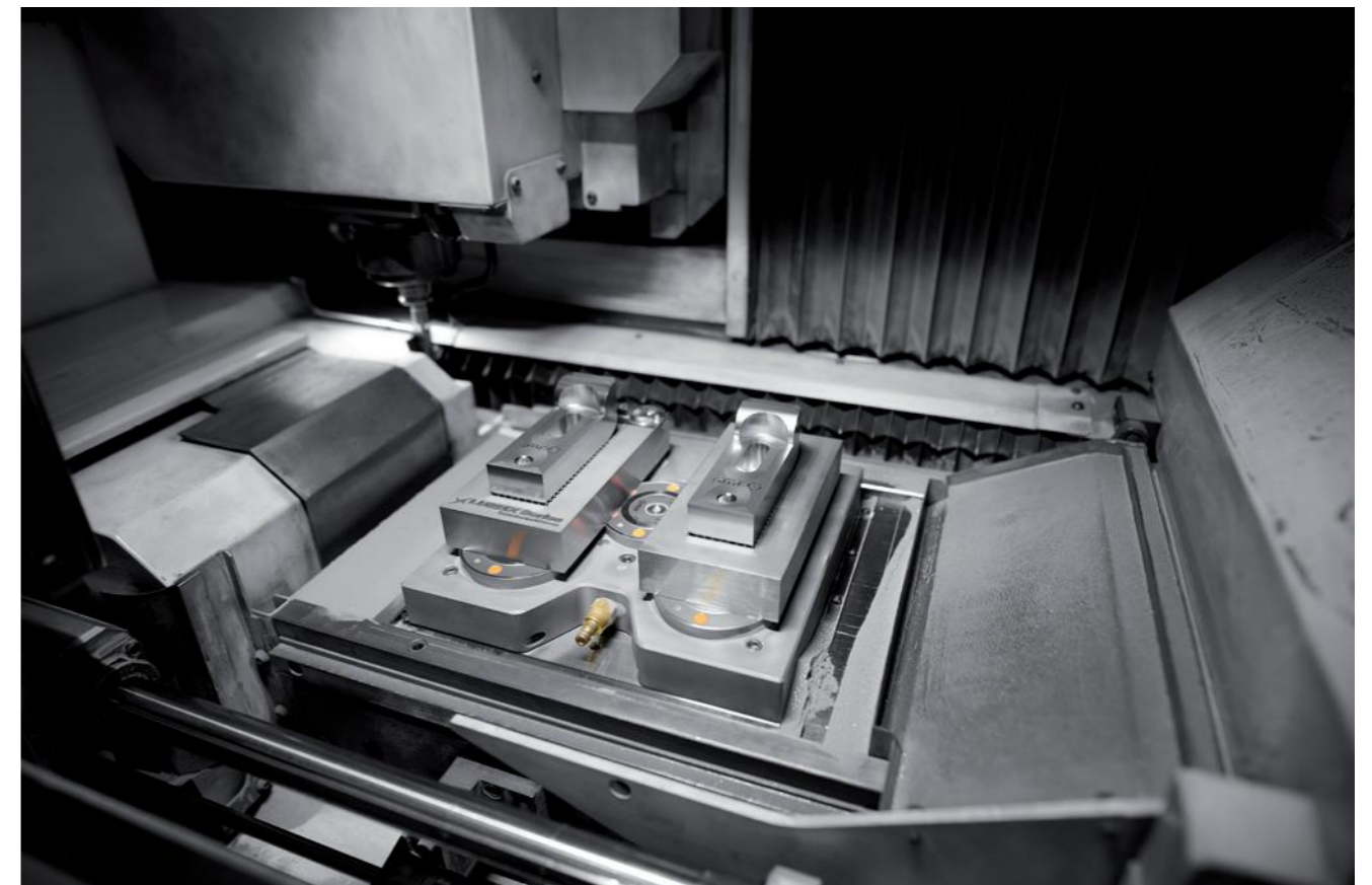
AMF专为增材制造（3D打印）和高温环境设计的零点定位系统。完全密封的设计，可以免受金属粉末的影响。
