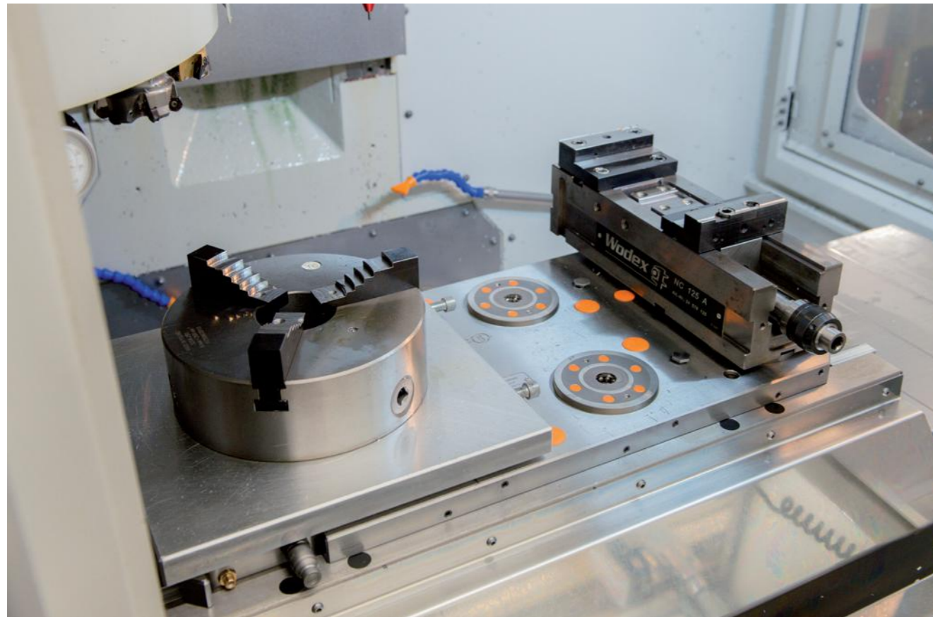
8单元零点定位系统实现虎钳、卡盘等夹具的快速切换
