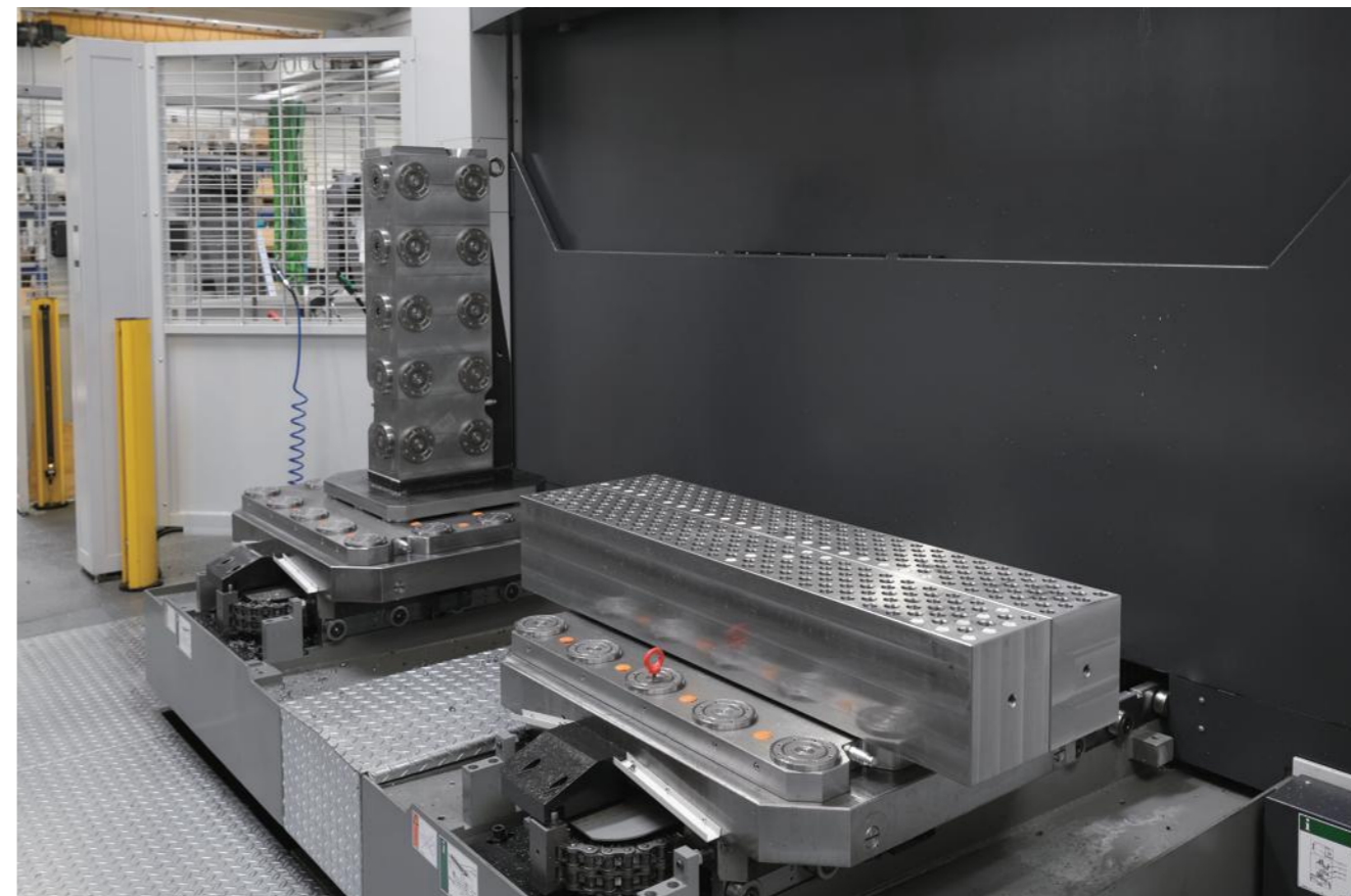
AMF零点定位系统用于深孔加工
