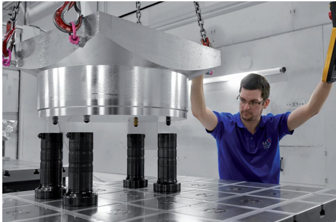
通过AMF零点夹紧技术，可最大限度的降低安装时间。
