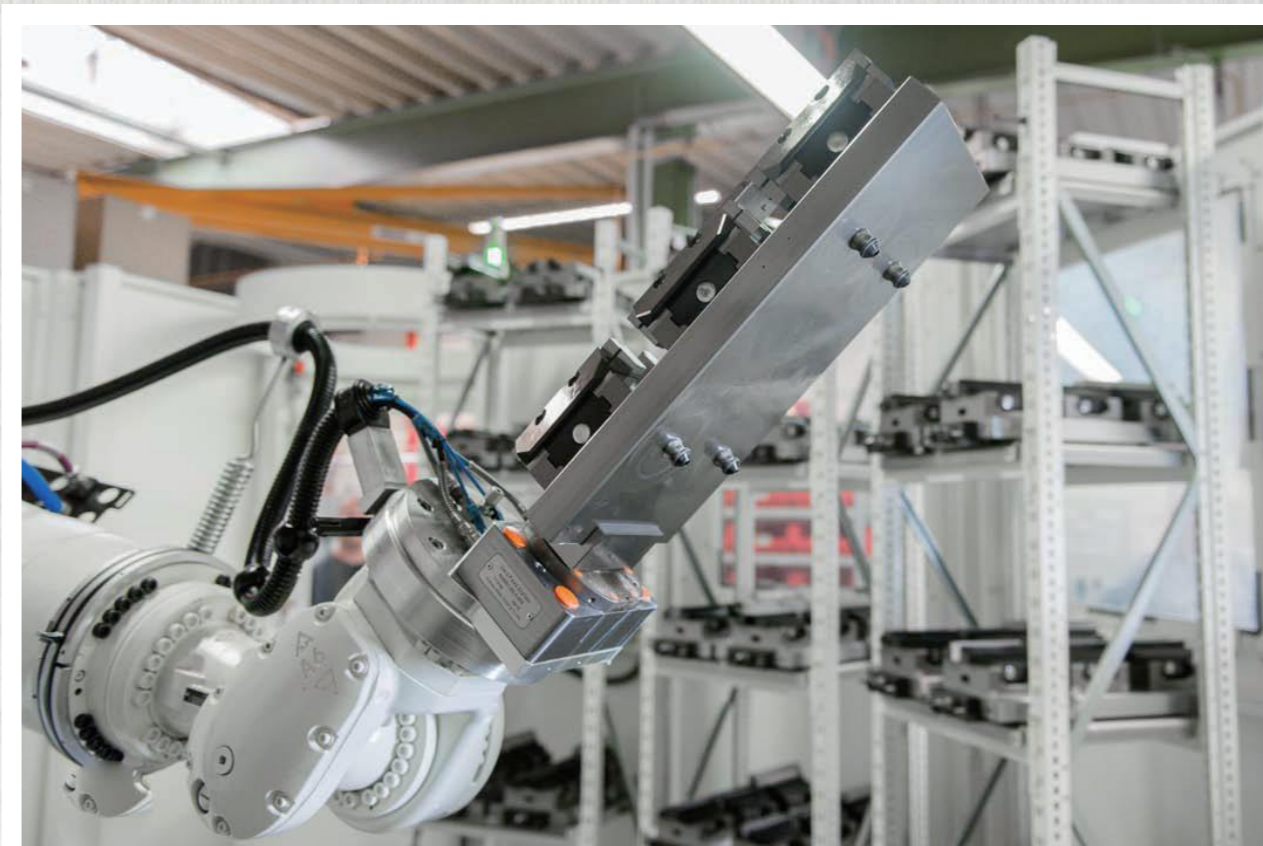
多种组合的传感器系统保证了机械手抓取的安全性
