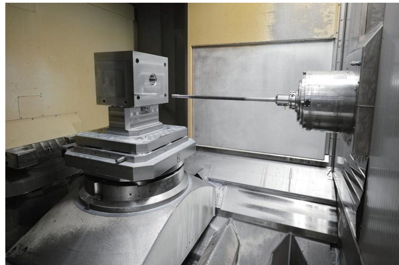
AMF零点定位系统用于深孔加工
